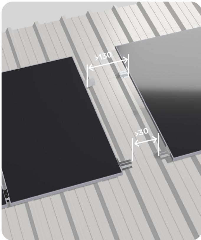
Si la longueur de l'installation dépasse les 17,6m, une séparation thermique d'au moins 130 mm est nécessaire.
