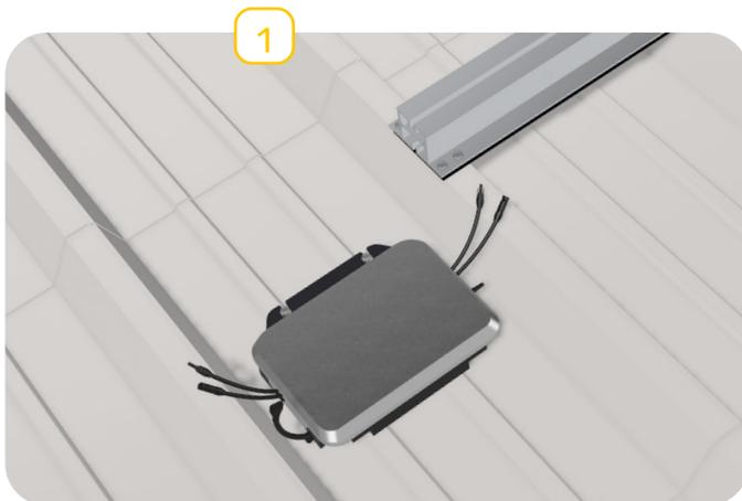
Fixation micro-onduleur directement sur le toit suivant la place disponible.
